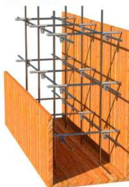
Modelo TPD para paredes com duas armaduras.
